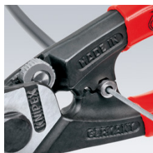
Anpressen der Endhülse an die Bowdenhülle
