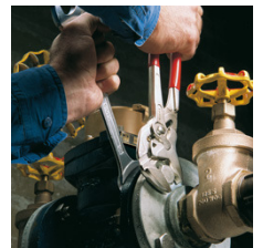
Herkömmlicher Schraubenschlüssel: Kantenpressung führt zu Beschädigung
