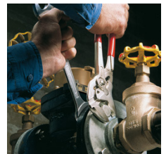
Herkömmlicher Schraubenschlüssel: Kantenpressung führt zu Beschädigung
